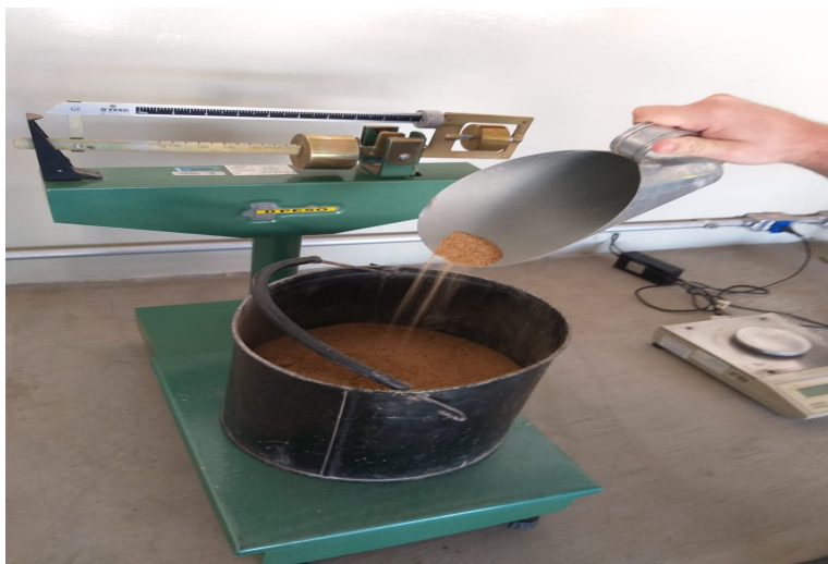
Figura 2: Pesagem do agregado miúdo
