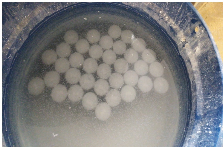
Figura 14: Cura dos corpos de prova 1
