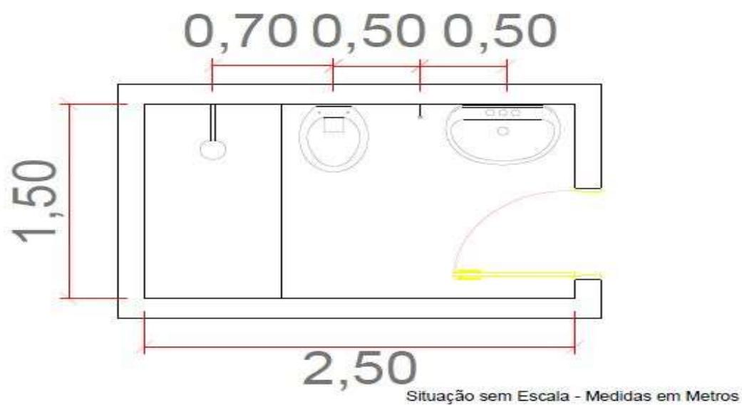
Figura 01: Planta baixa do banheiro com cotas. (fonte: As autoras, 2020).
