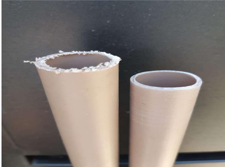
**Figura 06:** Tubo serrado à esquerda e tubo lixado à direita pronto para receber a cola. (fonte: As autoras, 2020).
