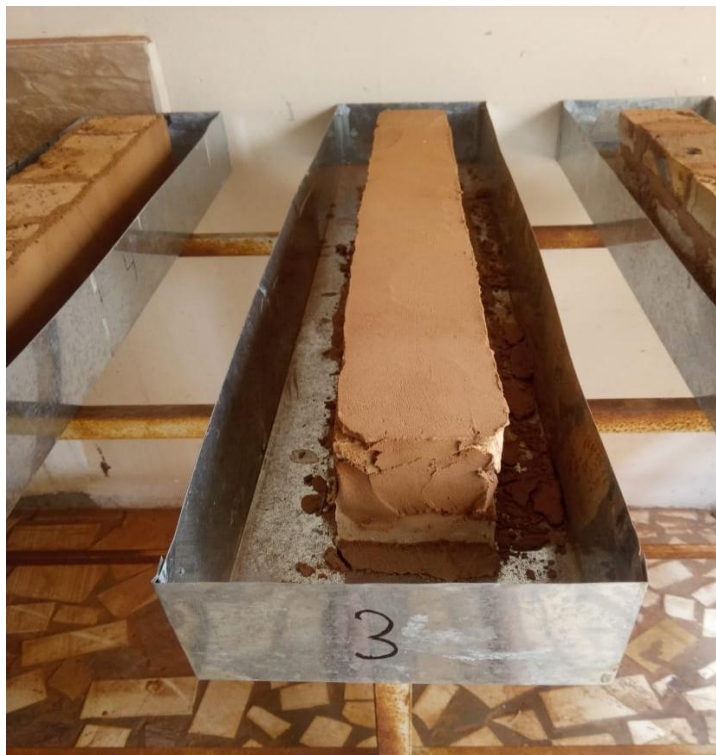
Figura 4 - Amostra 3 com reboco apenas na face superior.
