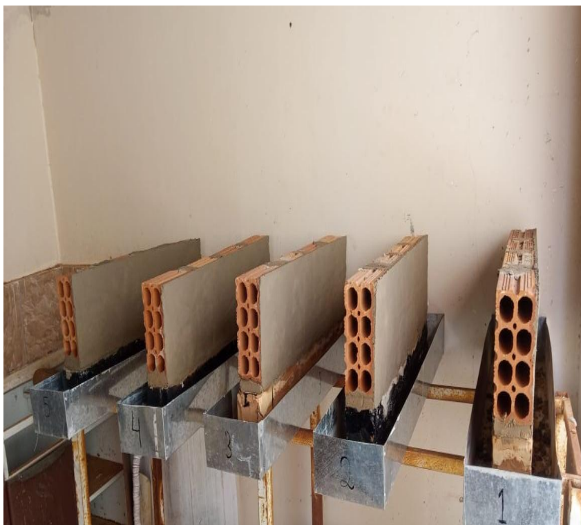
Figura 12 - Amostras de alvenaria de tijolos de 8 furos com reboco.
