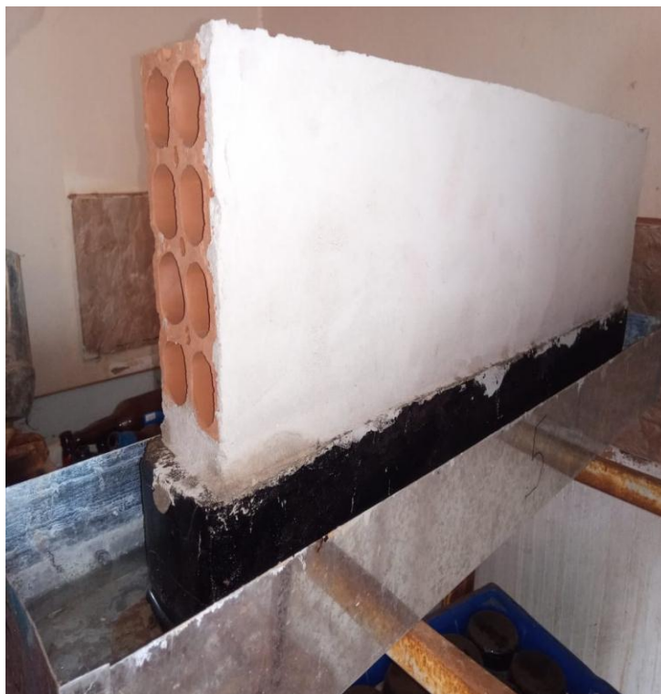
Figura 17: Amostra 5, com o surgimento de manchas de umidade no 5º dia.
