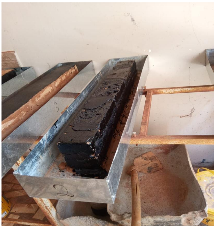
Figura 8 - Amostra 2 com impermeabilização total.
