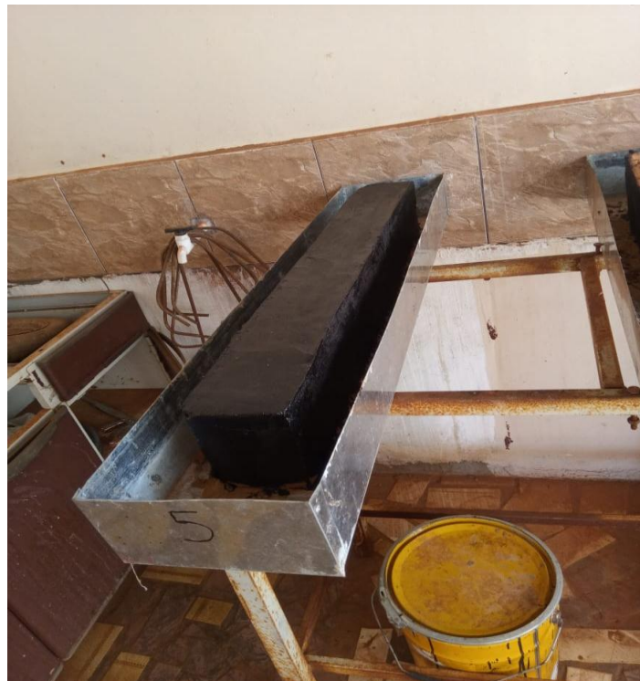
Figura 11 - Amostra 5 com impermeabilização total.
