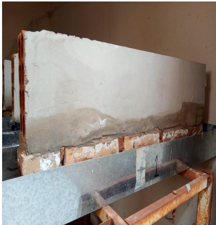
Figura 13 - Amostra 1 com o surgimento de umidade no 5º dia.
