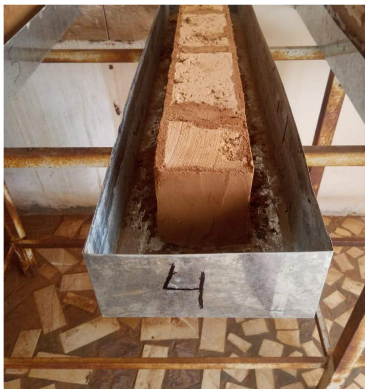
Figura 5 - Amostra 4 com reboco apenas nas faces laterais.
