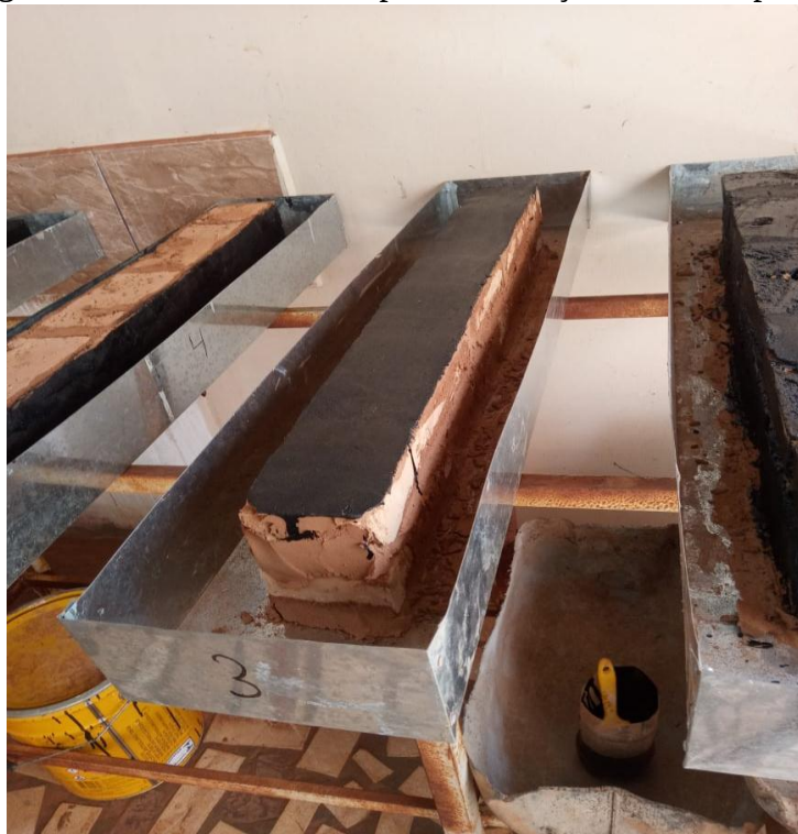
Figura 9 - Amostra 3 com impermeabilização na face superior.
