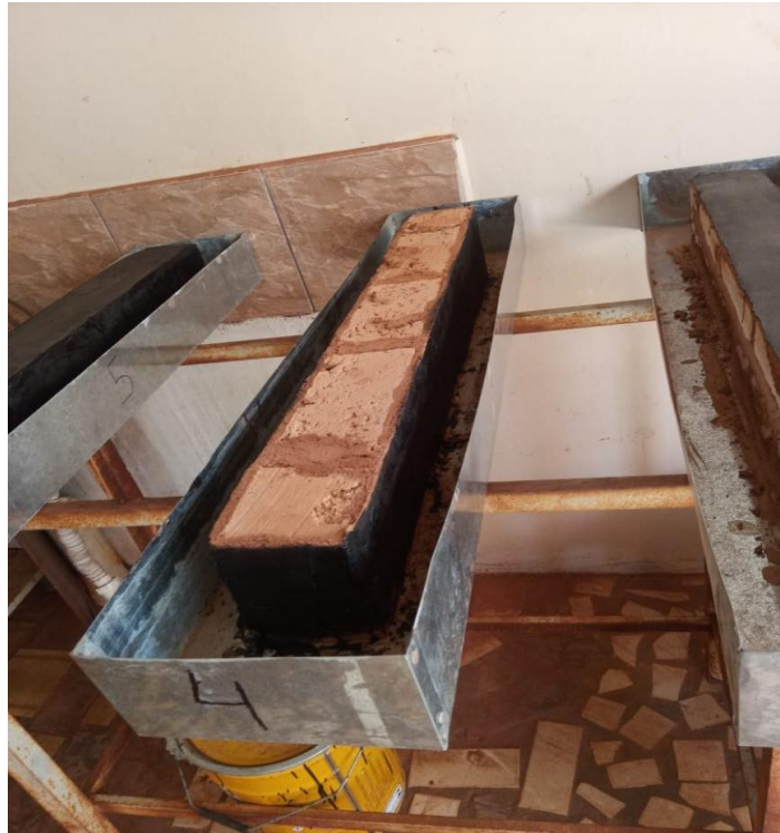
Figura 10 - Amostra 4 com impermeabilização nas faces laterais.
