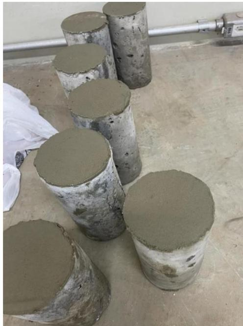
**Figura 11.** Aplicação de massa para nivelar e posterior rompimento. Fonte: Autores, 2022.
