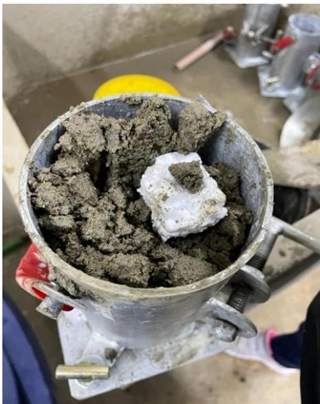
**Figura 4.** Adicionando isopor, para visualizar as fissuras. Fonte: Autora, 2022.
