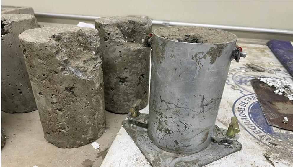
**Figura 6.** Voltando para o corpo de prova e aplicando o graute 40. Fonte: Autora, 2022.
