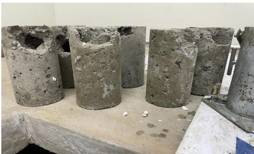
**Figura 5.** Retirados do corpo de prova e remoção do isopor. Fonte: Autora, 2022.
