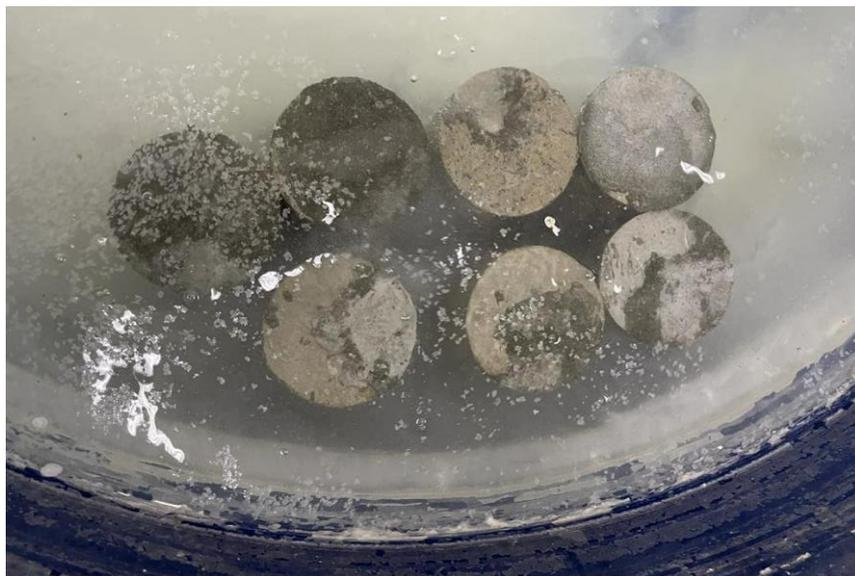
**Figura 9.** Tanque de cura em água saturada por cal. Fonte: Autora, 2022.
