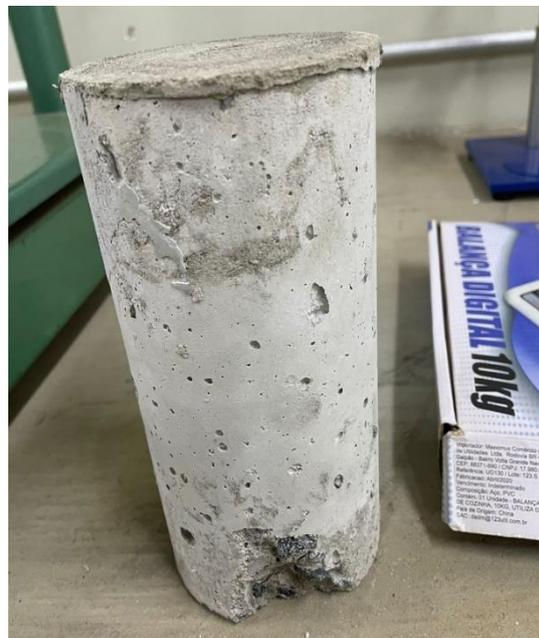
**Figura 13.** Corpos submetido ao teste, apresentando ruptura. Fonte: Autora, 2022.
