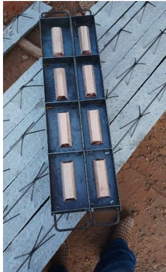
Figura 5: Forma criada para fabricação dos tijolos
