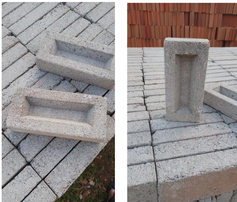
Figura 6. Resultado tijolo maciço de concreto. Fonte: Autores, 2022.
