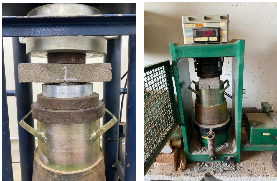
Figura 8. Amostra rompida. Fonte: Autores, 2022;
