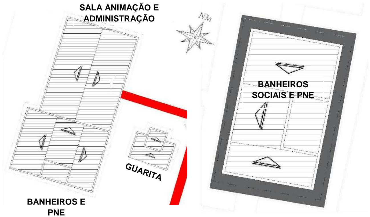
Figura 58. Planta baixa do telhado dos banheiros e sala de animação
